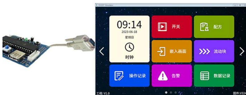
图 12-2 用户单片机串口与“虚拟 HMI”联机调试
