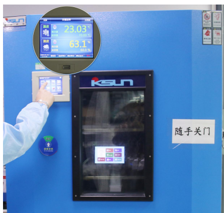
图 7-3 高低温老化测试图
